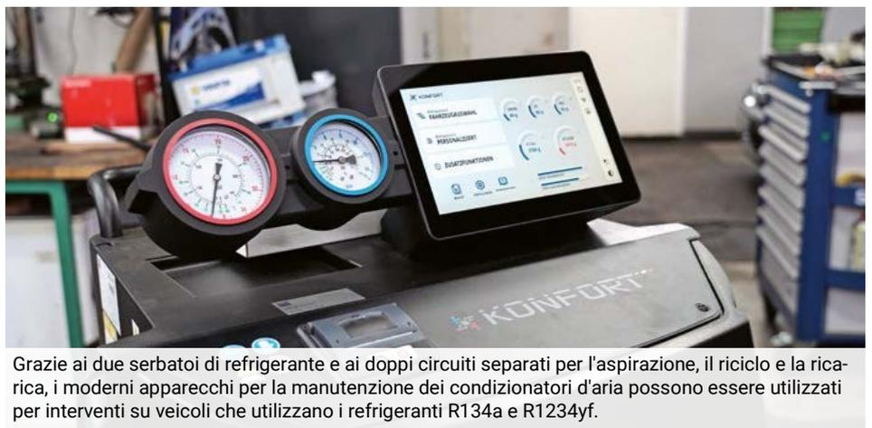
Grazie ai due serbatoi di refrigerante e ai doppi circuiti separati per l'aspirazione, il riciclo e la ricarica, i moderni apparecchi per la manutenzione dei condizionatori d'aria possono essere utilizzati per interventi su veicoli che utilizzano i refrigeranti R134a e R1234yf.
