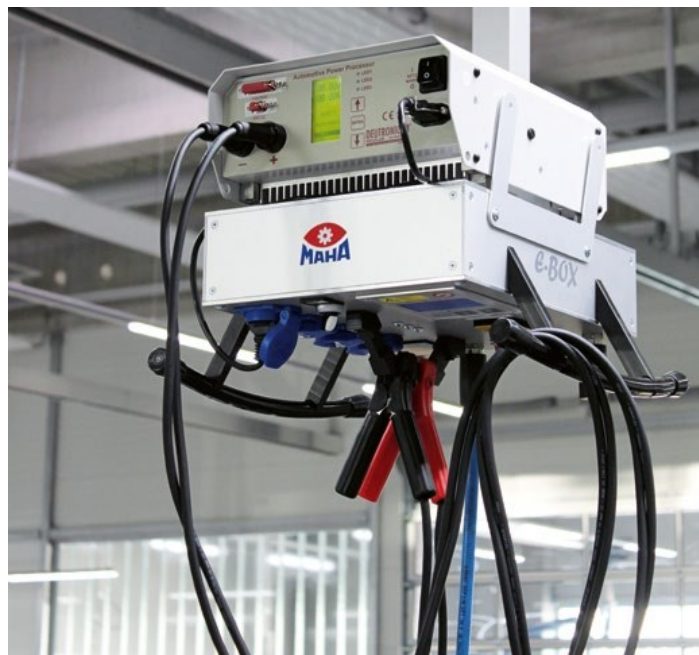
In officina, ogni postazione di lavoro dovrebbe essere dotata di un dispositivo di ricarica, in modo che la carica della batteria da 12 volt dell'impianto di bordo possa essere mantenuta anche durante tutta la fase di lavorazione.
