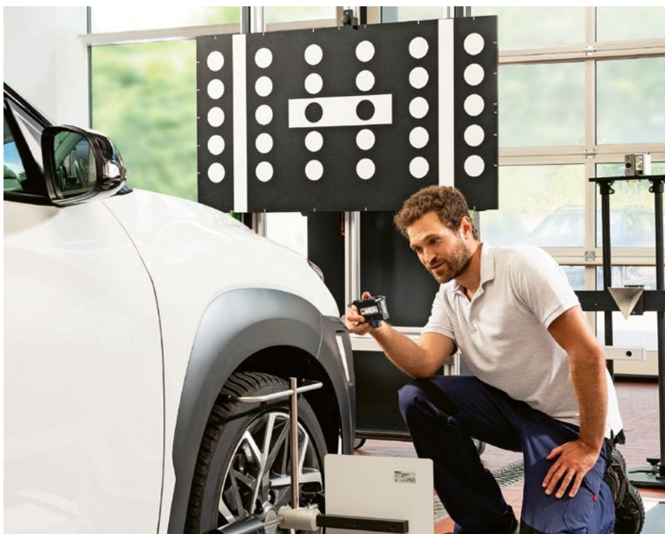
Numerosi fabbricanti offrono dispositivi di calibrazione analogici e digitali per scopi singoli o multipli: dall'apparecchio di base con tabelle analogiche alla stazione di calibrazione high-tech completamente digitale. Foto: Bosch
