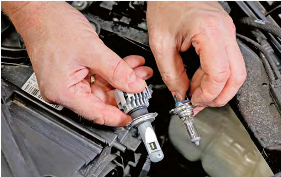
La lampadina retrofit a sinistra si adatta al portalampada del riflettore del faro. Il punto focale (emissione della luce a livello della lampadina) è identico a quello di una lampadina alogena a incandescenza e garantisce un preciso stacco chiaro-scuro. L'illuminazione è migliore, la sicurezza stradale aumenta, il consumo energetico diminuisce. Tuttavia, sono nel nostro Paese vietate.
