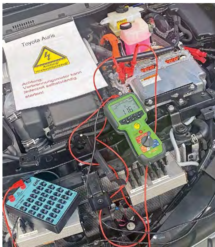
Diagnosi sull'ibrido: misurazione della tensione nel vano motore di una Toyota Auris nel rispetto delle misure di sicurezza per l'alto voltaggio. Foto: Harry Pfister
