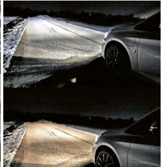
La lampadina retrofit a sinistra si adatta al portalampada del riflettore del faro. Il punto focale (emissione della luce a livello della lampadina) è identico a quello di una lampadina alogena a incandescenza e garantisce un preciso stacco chiaro-scuro. L'illuminazione è migliore, la sicurezza stradale aumenta, il consumo energetico diminuisce. Tuttavia, sono nel nostro Paese vietate.
