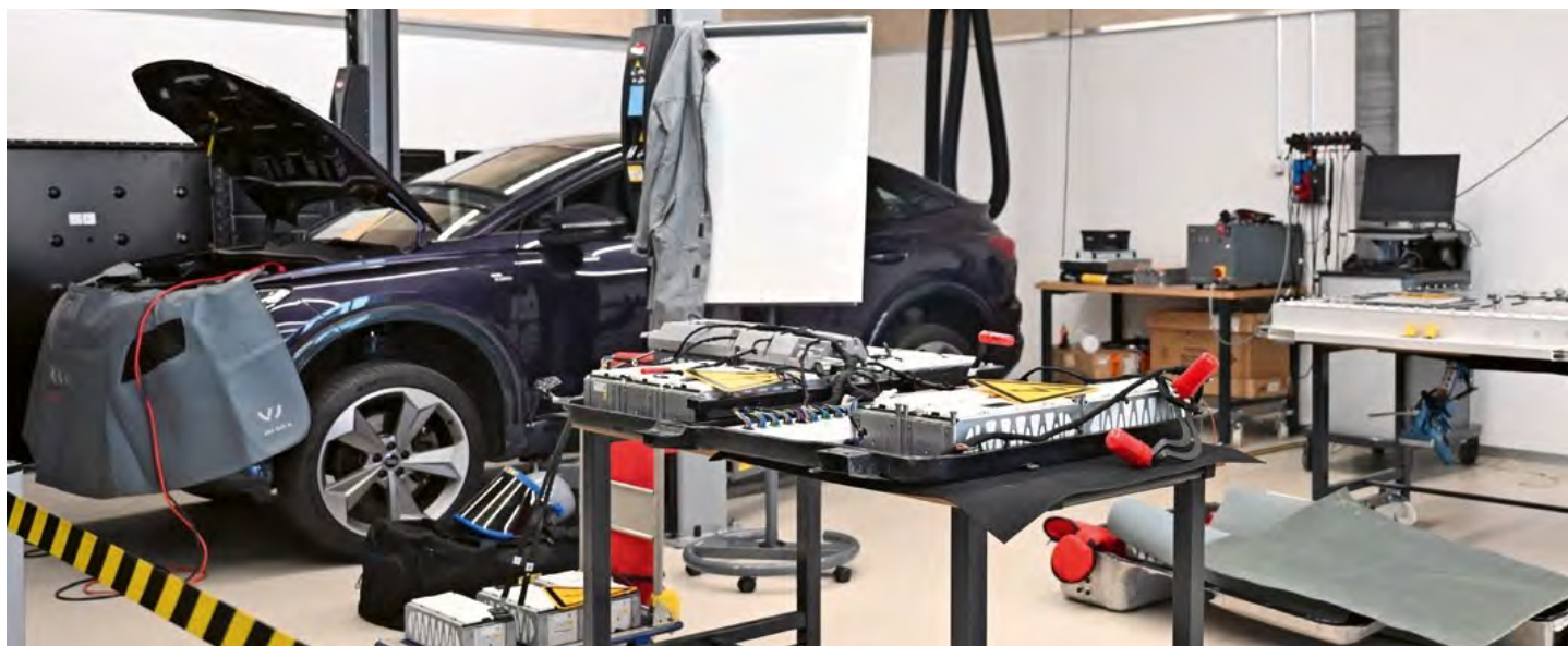
Moduli batteria e strumenti per la manutenzione e l'analisi del sistema ad alta tensione di un'Audi elettrica sono disponibili presso l'Academy by Amag Import. Foto: E-Roadmap
