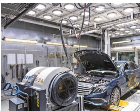
I produttori di componenti e i costruttori di automobili utilizzano sistemi di misura dei gas di scarico che costano milioni per effettuare misure precise e riproducibili su banco di prova (a sinistra) o su strada (a destra). Foto: Mercedes
