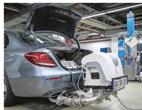
I produttori di componenti e i costruttori di automobili utilizzano sistemi di misura dei gas di scarico che costano milioni per effettuare misure precise e riproducibili su banco di prova (a sinistra) o su strada (a destra). Foto: Mercedes
