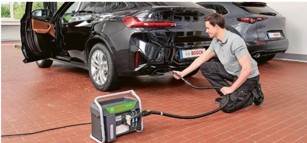
La misura del numero di particelle per cm 3 d'aria nel tubo di scarico richiede un apparecchio di controllo specifico, la cui manutenzione è essenziale per evitare errori di misura e fornire informazioni corrette sullo stato del FAP. Foto: Bosch
