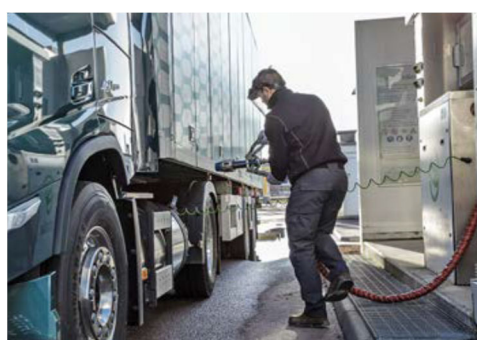
Il gas liquefatto entra nel serbatoio ad una temperatura di -160 °C. Quando si fa il pieno, delle misure di precauzione permettono di evitare di bruciarsi con il carburante e le connessioni molto fredde. Foto: Volvo
