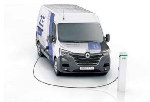
Dal lato dei veicoli utilitari leggeri, il motore elettrico a batteria è una tecnologia accettabile. In questo caso, maggiore è l'autonomia richiesta, più pesanti sono le batterie e minore è il carico utile. Foto: Renault
