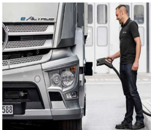
Un veicolo utilitario deve poter viaggiare per essere redditizio. Di conseguenza, i tempi di rifornimento sono molto importanti. Le prese di ricarica rapida CC permettono di raggiungere l'80% della capacità/autonomia in due ore. Foto: Mercedes-Benz
