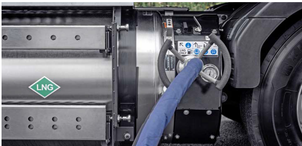
Il GNL è un'opzione interessante che può essere già utilizzata in tutta la Svizzera e permette di ridurre in un sol colpo del 20% le emissioni di CO 2 . L'autonomia permessa è però minore che quella di un motore diesel, ma permette comunque un rifornimento rapido. Il BGL permette quasi di raggiungere la neutralità di emissioni di CO 2 . Foto: Volvo
