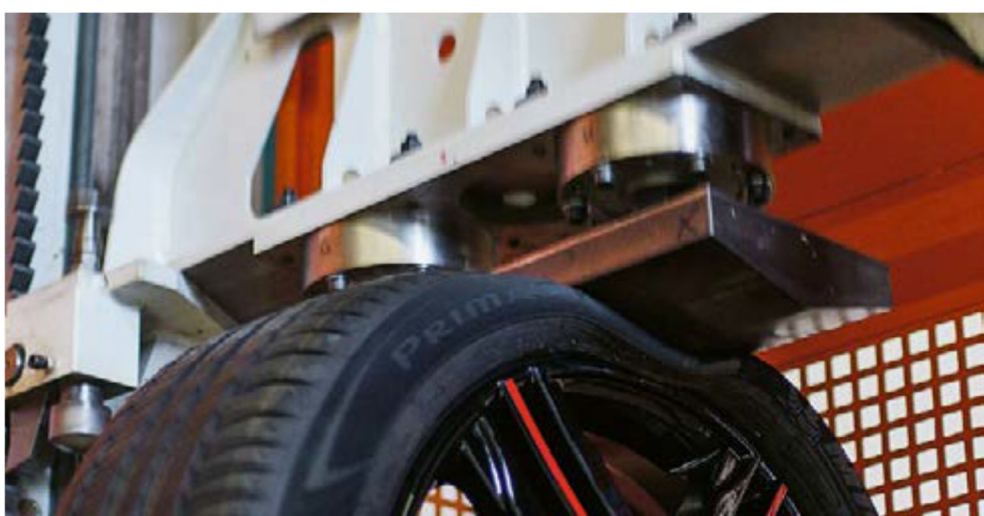
Analisi della robustezza durante i test dinamici (in alto) e statici: i più affidabili produttori di ruote testano i loro prodotti durante lo sviluppo per vendere ai clienti ruote impeccabili in termini di sicurezza. I fornitori a basso costo che offrono i loro prodotti su Internet a prezzi molto bassi rinunciano alla garanzia di qualità durante la produzione e ai costosi processi di sviluppo. Per garantire la robustezza, le ruote sono state stampate con pareti più spesse e risultano quindi molto più pesanti. Foto: Ronal
