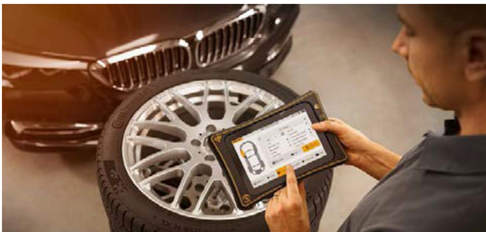
L'Autodiagnos Tire 300, un apparecchio completo: telecamera, modulo OBD II, interfaccia RJ45, chip RFID e connessione Wi-Fi. Foto: Continental
